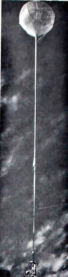
DURANTE EL ASCENSO -- Momentos después de soltadas las amarras, el globo del Estratoscopio II asciende con todos sus aparatos. Del globo auxiliar cuelga todavía desinflado el globo principal que parece un cable. Más abajo se ve el telescopio. El ascenso lo hace a 240 metros por minuto. (No. 65-1668)
