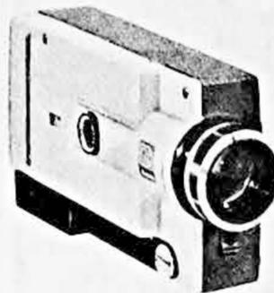
Estupendos cambios ópticos. La nueva Cámara de Cine KODAK INSTAMATIC M6 tiene un luminoso lente varifocal ("zoom") f/1.8, visor de imagen reflejada, y control automático de exposición. Mango de pistola, plegable. Un modelo semejante, el M5, ofrece óptica varifocal a menor precio.
