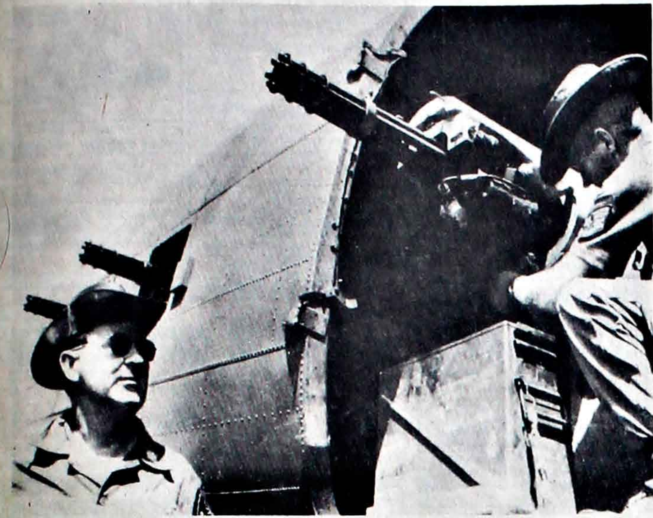
Este avión C-47, anterior a la segunda guerra mundial ha sido adaptado para su uso en el conflicto vietnamita. A cada lado del fuselaje del avión se han abierto tres troneras por donde apuntan ametralladoras de seis caños, cada una de las cuales puede disparar 6.000 balas por minuto. El avión puede estar planeando durante varias horas sobre puestos sitiados o zonas en que su apoyo es necesario. Esta adaptación fue mostrada el 23 de noviembre a los periodistas que se hallaban en Saigón. El IV Comando Aéreo ya tiene 25 de estos aviones listos para ser usados (AP Wirephoto).
