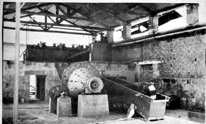
Esta maquinaria construida por técnicos y trabajadores de "METABOL", corresponde a la sección de Limpieza de los concentrados de Estaño. Estos, tienen porcentajes considerables de impurezas. El 85% del equipo instalado de acuerdo al plan de remodelación, está construido en el país. Esta labor ha motivado un considerable ahorro de divisas y ha demostrado la capacidad de los técnicos y trabajadores nacionales.
