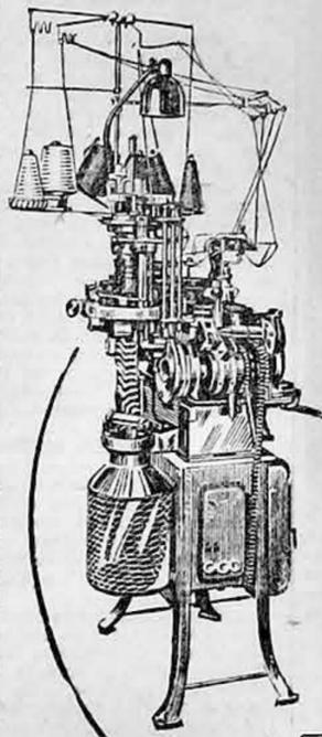
Son máquinas enteramente automáticas, para la fabricación racional de toda clase de géneros elásticos y tejidos de malla, lisos o cotelados, vanisados, rayados transversalmente o con dibujos plásticos.
